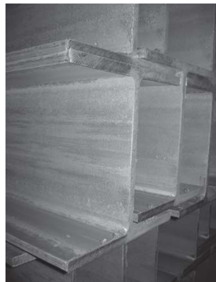
写真1 安徽省の中国メーカーが製造するH形鋼 （写真は中国本土向け。輸出品とは区別して保管されていた）
