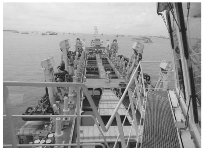
写真7 自航式浚渫船の艦橋から船首方向を見る。中央に容積20,000m<sup>3</sup>のホッパーを擁し、浚渫した土砂を運搬する。
