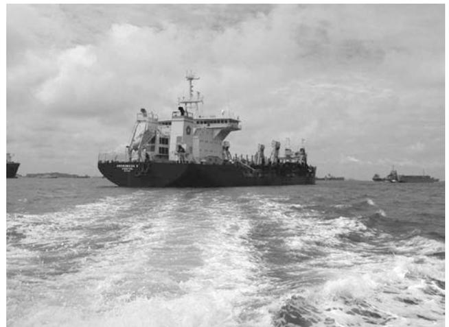
写真6 自航式浚渫船を後ろから見る。船側に水中浚渫ポンプが取り付けられている。
