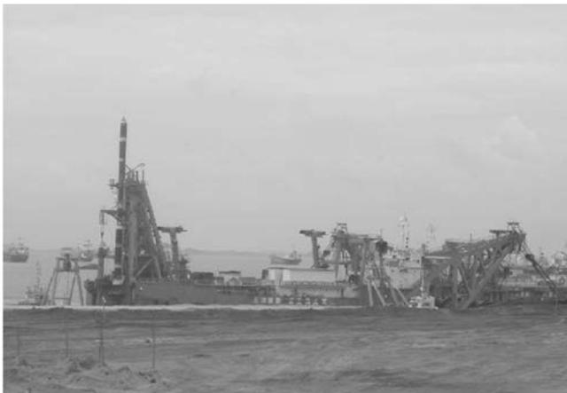
写真8 埋め立て現場越しにポンプ浚渫船を見る。スエズ運河開削工事でも活躍した船だが、シンガポールでも変わらずに活躍している。
