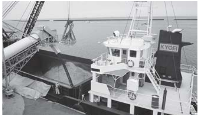
図表14 ガット船への積み込み①
