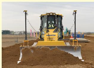
マシンコントロール搭載ブルドーザー
