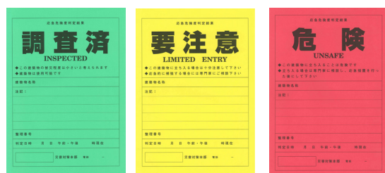
【図-1 応急危険度判定で用いるステッカー】
