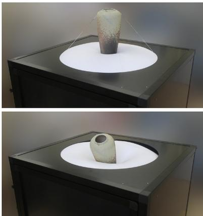
【写真 文化財を地震から守るためのレジリエントシステム：AL (Ant Lion もしくは Artificial Liquefaction) 免震は緊急地震速報を受信するとすばやく文化財をマットの中に沈め込ませる】
