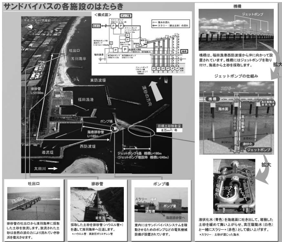
図表20 「固定式ジェットポンプによるパイプライン輸送方式」によるサンドバイパス事業
