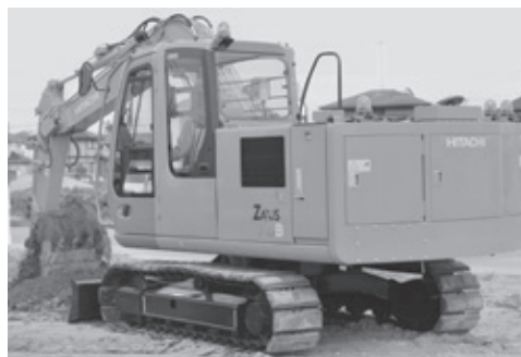
図表7 バッテリー駆動式油圧ショベル ZX70B (2007年)
