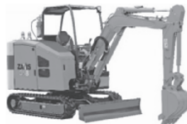
図表8 バッテリー駆動式ミニショベル ZX35B (2010年)
