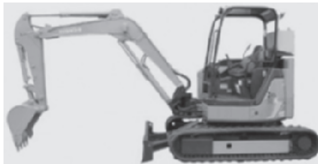
図表6 バッテリー駆動式ミニショベル ZX50UB-2 (2006年)
