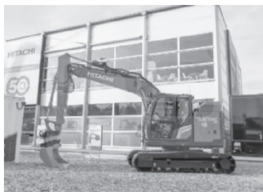
図表16 13トンクラスバッテリー駆動式ショベル
