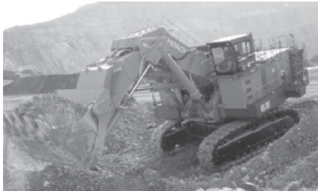
図表23 当社の代表的な電動超大型油圧ショベルEX5600E-6
