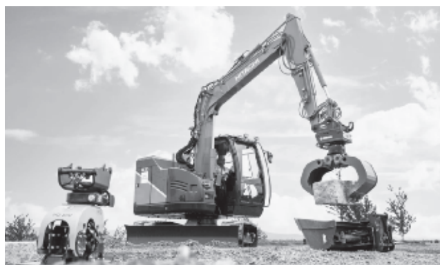
図表14 8トンクラスバッテリー駆動式ショベルZE85
