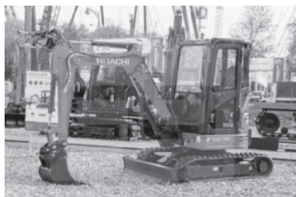
図表15 2トンクラスバッテリー駆動式ショベル
