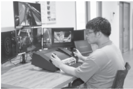
図表18 掘削シミュレーター(アメリカENDEVOR社製モデルX3)
