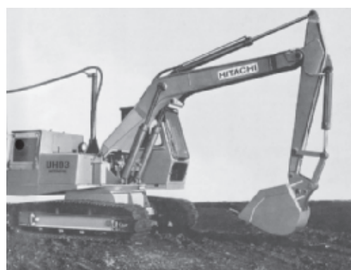
図表3 電動式油圧ショベルUH03E(1971年)
