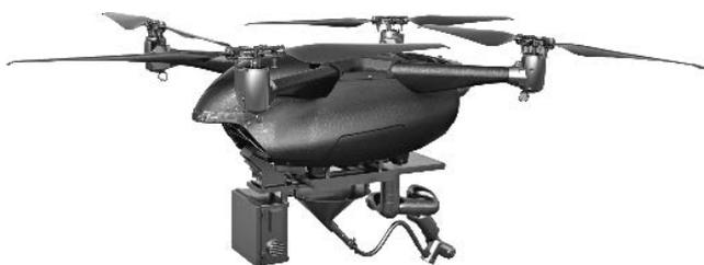
生するものと予想される。ノズルの先端を目標位置に絶え間なく合わせるため、ノズルを細かく制御する小型ロボットアームと、前バッチで積層したプリント層を認識し続けるカメラを搭載し、ノズルの先端が絶えず目標に追従してターゲットへの正確なプリントを可能とするシステム開発が必要である(図表7)。本システムは株式会社チトセロボティクス(本社：東京都文京区)と共同で開発を行っている。また、ドローンに搭載する超軽量型の積層材料圧送ポンプの開発も兵神装備株式会社(本社：神戸市兵庫区)と共同で行っている。
