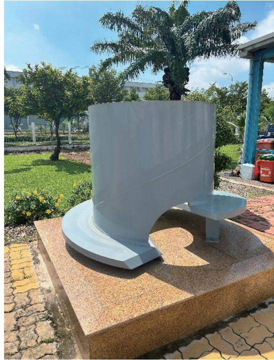
【図表-13 先端羽根付き鋼管】
