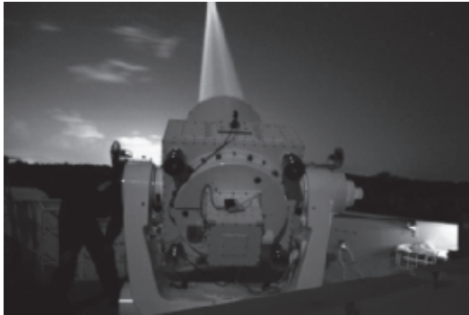
図表19 海上保安庁 下里水路観測所のSLR施設 (和歌山県那智勝浦町)
